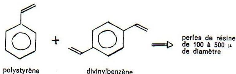
La vitesse des échanges doit être aussi rapide que possible, la résine doit donc être finement divisée afin de présenter une grande surface de contact avec la solution ; c'est sous forme de perles très fines que la plupart des échangeurs d'ions sont généralement utilisés.
