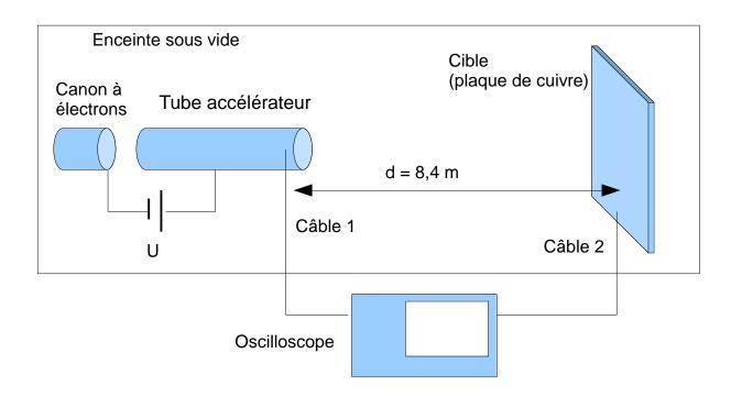
**Données** : pour l'électron  $m_e = 9.109~382~91$  .  $10^{-31}~kg$  charge élémentaire e = 1.602~176~565 .  $10^{-19}~C$  célérité de la lumière  $c = 299~792~458~m~s^{-1}$
