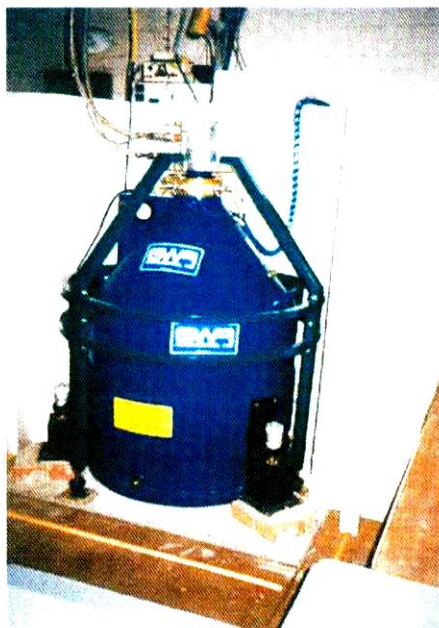
figure 12 : Gravimètre supraconducteur de l'observatoire gravimétrique de Strasbourg
