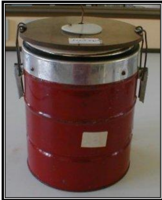
Calorimètres dit calorimètre de Berthelot
