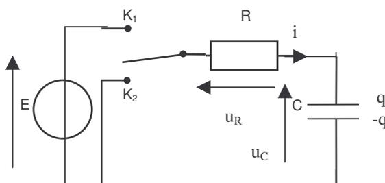
Pour la charge : interrupteur en position  $K_1$                       Pour la décharge : interrupteur en position  $K_2$
