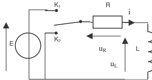
Pour l'établissement du courant : interrupteur en position  $K_1$       On supprime E : interrupteur en position  $K_2$
