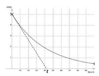
$\boldsymbol{t}$  est le temps caractéristique de fuite du réservoir : au bout de  $3\boldsymbol{t}$  à  $5\boldsymbol{t}$  le réservoir peut être considéré comme complètement vide.
