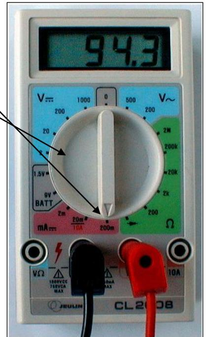
➤ Pour mesurer l'intensité d'un courant électrique en un point d'un circuit fermé, on doit brancher l'ampèremètre **en série** en ce point. Le courant électrique doit rentrer par la borne **A** et sortir par la borne **COM** que l'on précisera sur un schéma normalisé.
