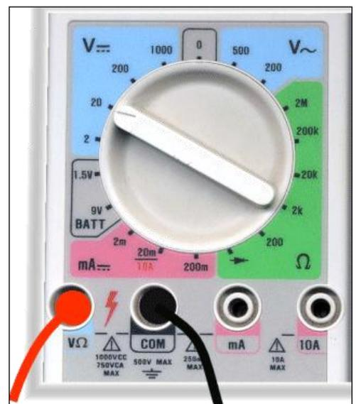
➤ Pour mesurer la tension électrique *entre deux points* d'un circuit fermé, on doit brancher le voltmètre **en dérivation** *entre ces points*. La borne **V** doit être reliée vers la borne + du générateur et la borne **COM** vers la borne - :
